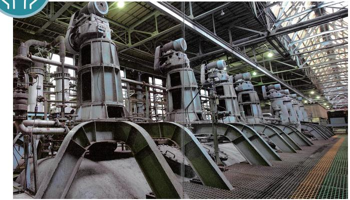
製造プロセスにおける最大の特徴は唯一無二の「ヘマタイト法」を採用していることです。このヘマタイト法により当社で生産する金属の種類や回収率は、他所と比較しても群を抜いており、限りある資源を最大限活かすことができます。また金属回収の過程で得られる副産物はいずれも有効に利用されています。廃棄物を極限まで減らす技術として世界的な評価を得ています。
